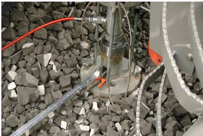
Прочность на сжатие уплотненной площади может быть проверена плитой, работающей на сжатие..
